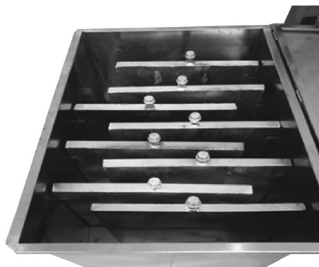
图2 相变储能水箱实物图
