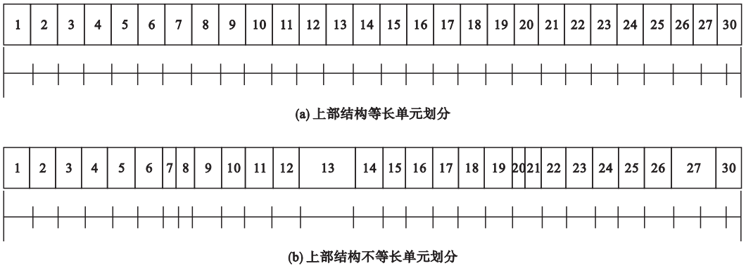
图 6 III 类子构件上部结构单元划分
