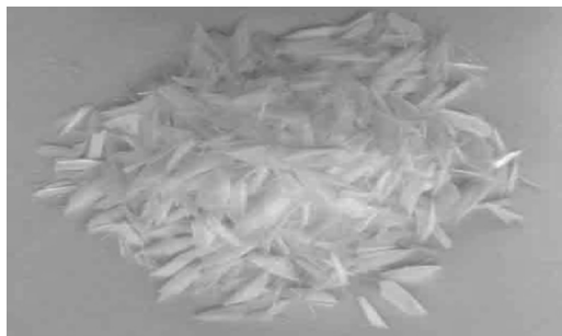
图 1 聚丙烯纤维的形貌
