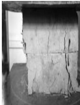
(b) 竖向裂缝发展
