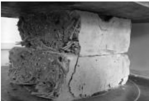
(a) 竖向裂缝出现
