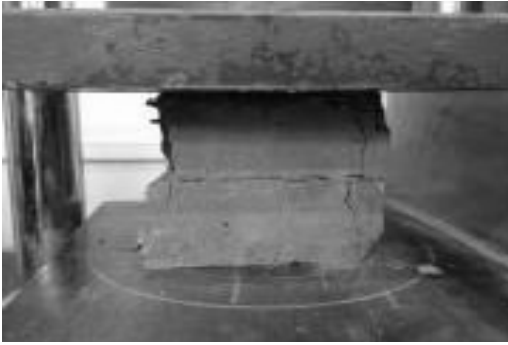
(a) 竖向裂缝出现
