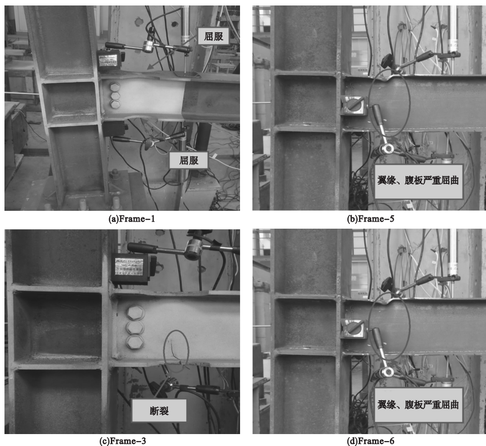
图5 狗骨式节点的破坏模式
